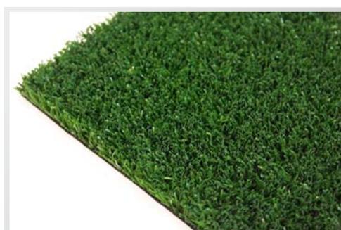
• Césped artificial de 17mm de altura total, diseñado para la práctica de tenis, pádel, o multideporte, fabricado mediante "tufting" con hilo monofilamento, de cinta plana de polietileno
